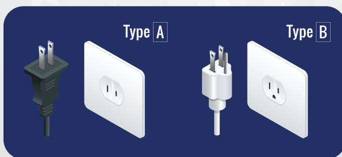
En los EE.UU. hay dos tipos de enchufe asociados, los tipos A y B. El tipo de enchufe A es el enchufe que tiene dos pines paralelos planos y el tipo de enchufe B es el enchufe que tiene dos pines paralelos planos y un pin de conexión a tierra. USA opera con una tensión de alimentación de 120V y 60Hz.
